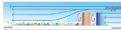
Figura 31. Perfil esquemático 01 com demonstração do padrão da ventilação na região da planície. Fonte: MELO (2009).
