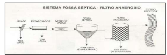
Figura 164. Fluxograma Típico de um Sistema Fossa Séptica seguida por Filtro Anaeróbio. Fonte: Von Sperling, 1995.
