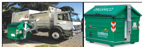
Figura 3. Contêineres de coleta mecanizada utilizada no município de Caxias do Sul. Fonte: CODECA (2016).
