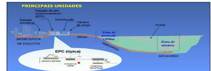
Figura 72. Principais unidades que compõem um sistema de disposição oceânica. Fonte: TREVISAN et al.
