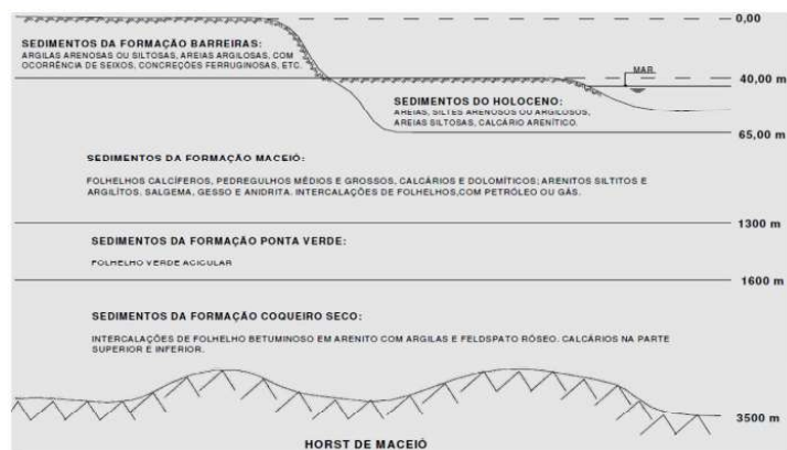
Figura 35. Perfil geológico simplificado da cidade de Maceió. Fonte MARQUES, (2004) apud MARQUES & MARQUES (2005).
