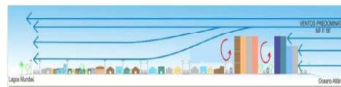
Figura 31. Perfil esquemático 01 com demonstração do padrão da ventilação na região da planície. Fonte: MELO (2009).
