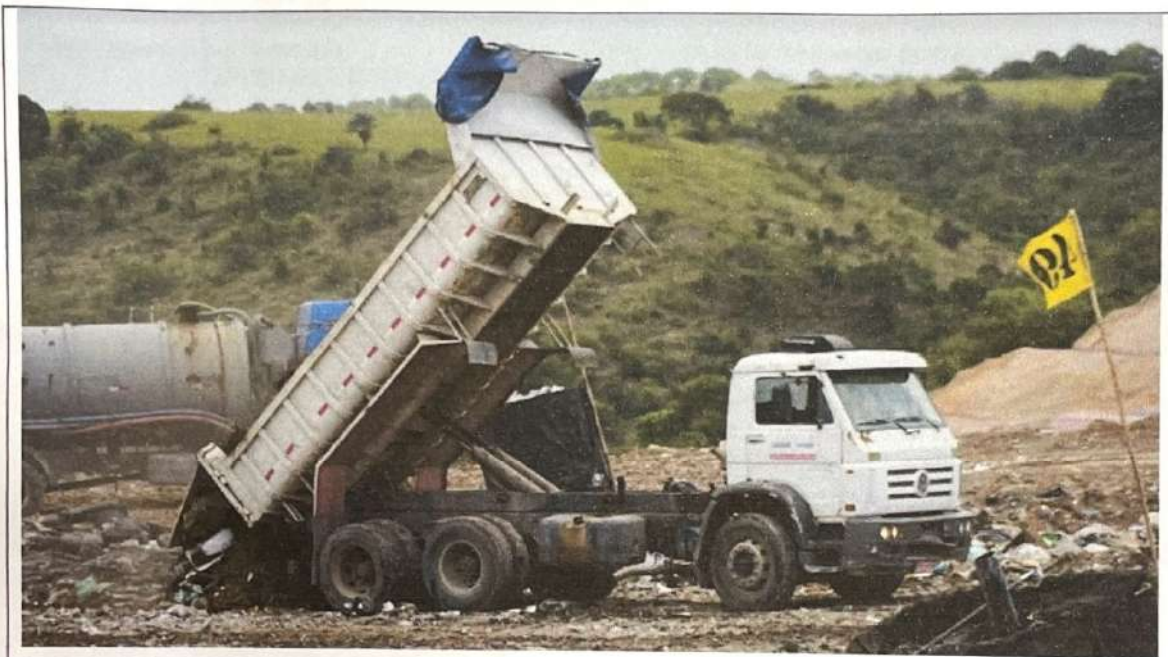
Figura 1: Caminhão descarregando resíduos de classe IIB na célula de resíduos domiciliares.
